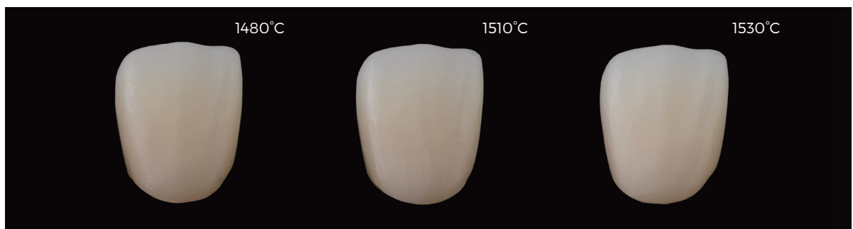
图 魅影·全能型A2前牙桥体在1480°C、1510°C、1530°C烧结温度下的效果对比
